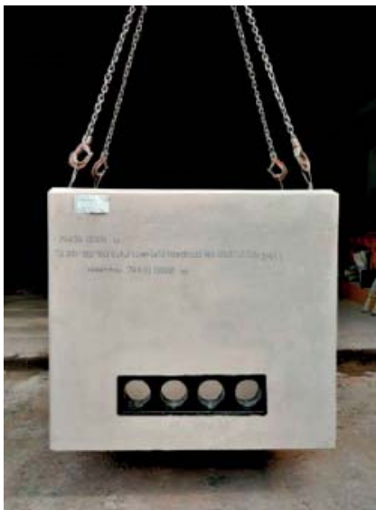
Anschlagen mit Seilschlaufen
